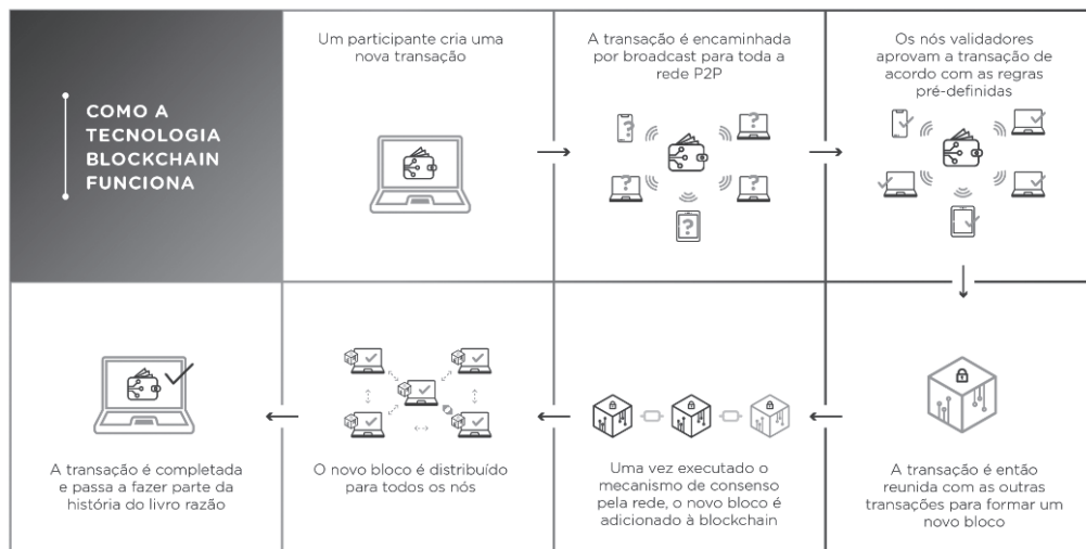
FIGURA 5 – Funcionamento genérico de uma blockchain
